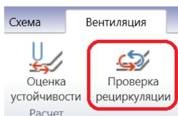
После нажатия на эту кнопку будет отображено сообщение с общим количеством найденных контуров, и, если таковые будут найдены, будет включён режим их подсветки (Вид -> Вентиляция -> Модельные данные -> Выработки -> Рециркуляционные контуры).
