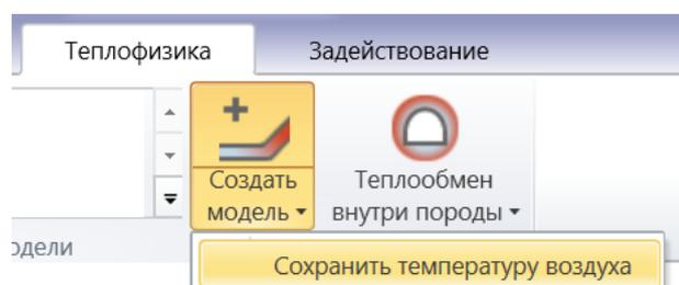
В этом случае температура воздуха в каждом узле будет задана на основе вычисленной температуры воздуха в этом месте для текущего модельного времени.
