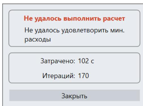
В этом случае следует изменить тип вентилятора на более мощный или, если это идеальный вентилятор, указать большее значение максимального напора.
